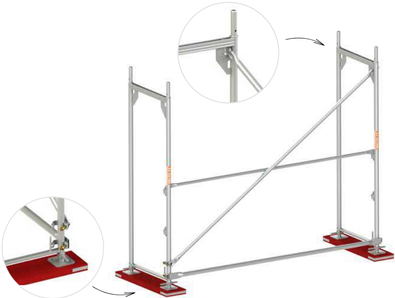
Rys. 4. Montaż pierwszych ram pionowych, poręczy i stężenia ukośnego w polu bazowym.
