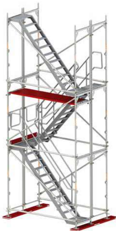
Rys. 44. Montaż klatki schodowej etap V.
