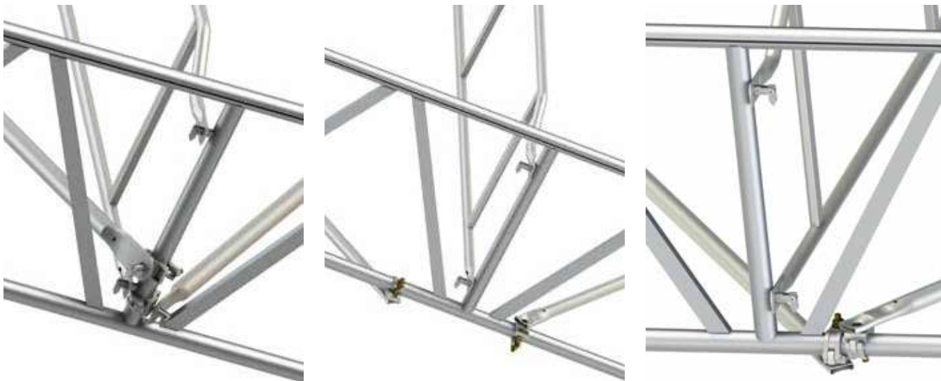
Rys. 58. Szczegół zamocowania stężeń dachowych.
