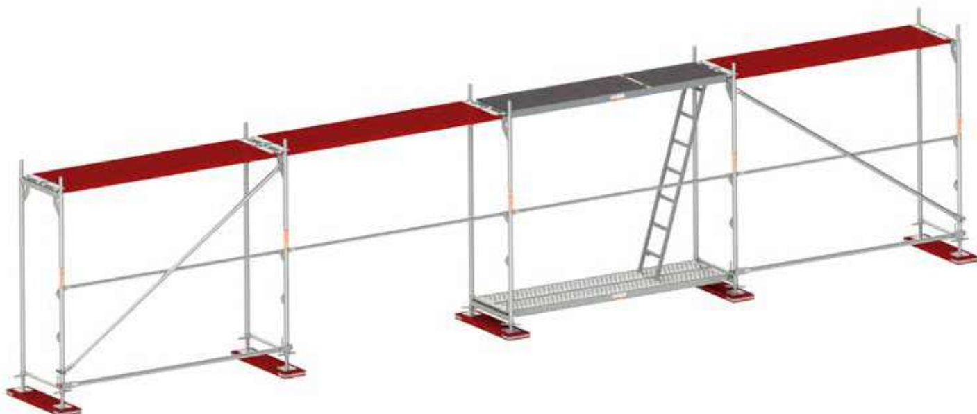
Rys. 6. Zmontowane kolejne pola pierwszej kondygnacji.
