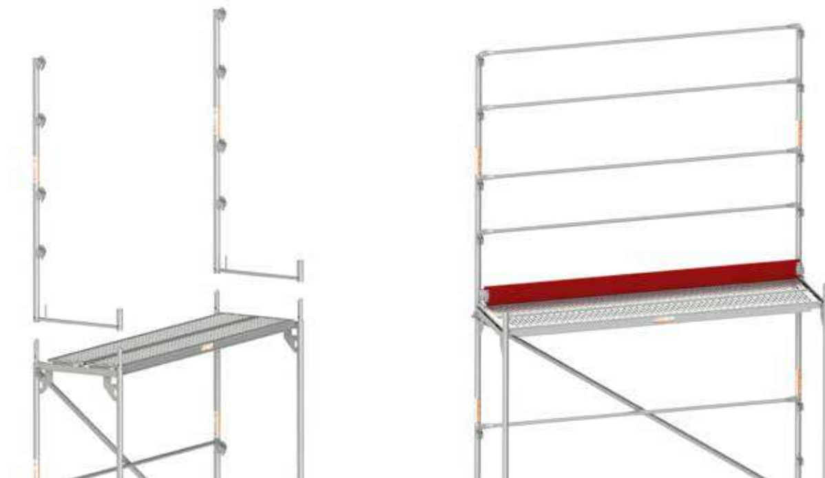
Rys. 18. Montaż słupków dekarских.
