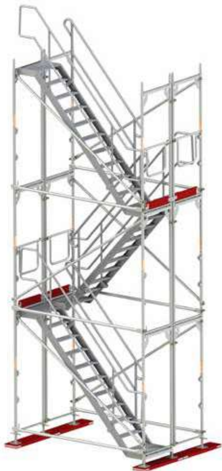
Rys. 45. Montaż klatki schodowej etap VI.
