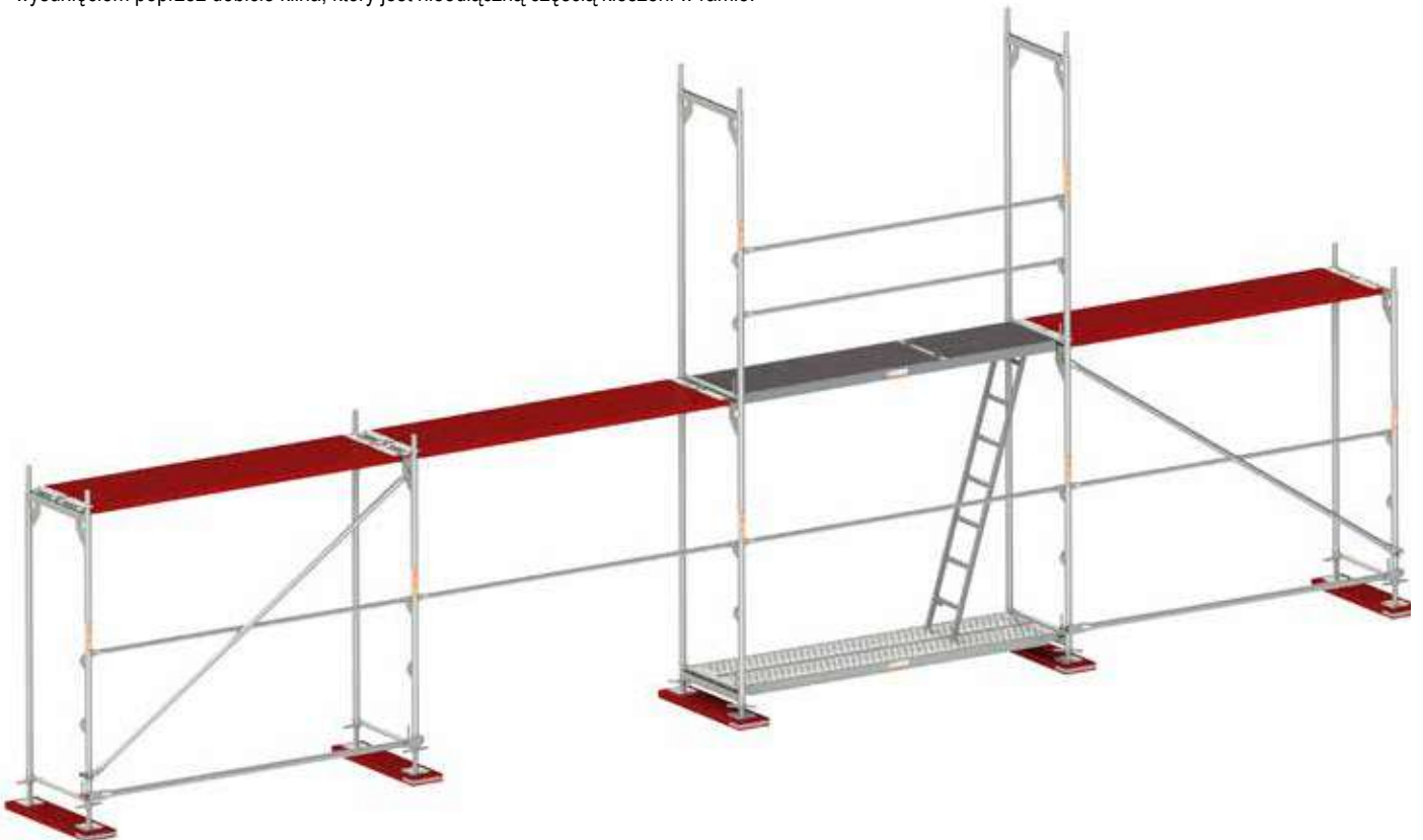
Rys. 8a. Montaż pierwszych ram i poręczy drugiej kondygnacji.
