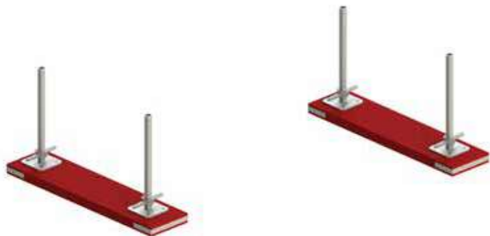
Rys. 2a. Posadowienie rusztowań na podkładach drewnianych.
