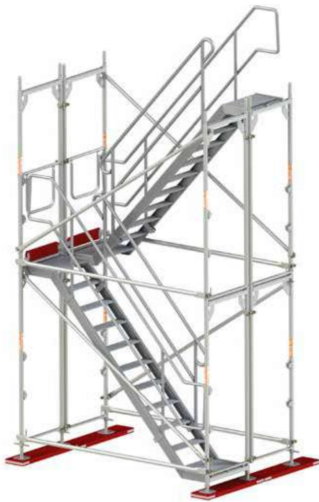
Rys. 43. Montaż klatki schodowej etap IV.
