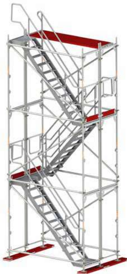
Rys. 46. Montaż klatki schodowej etap VII.
