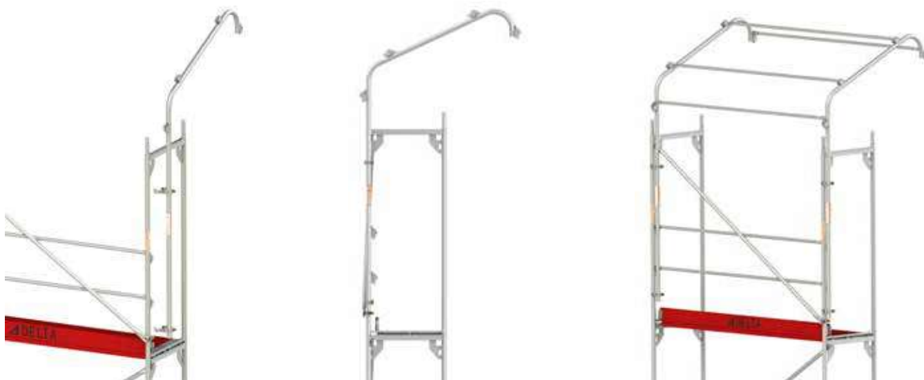
Rys. 19. Montaż słupków dachowych.
