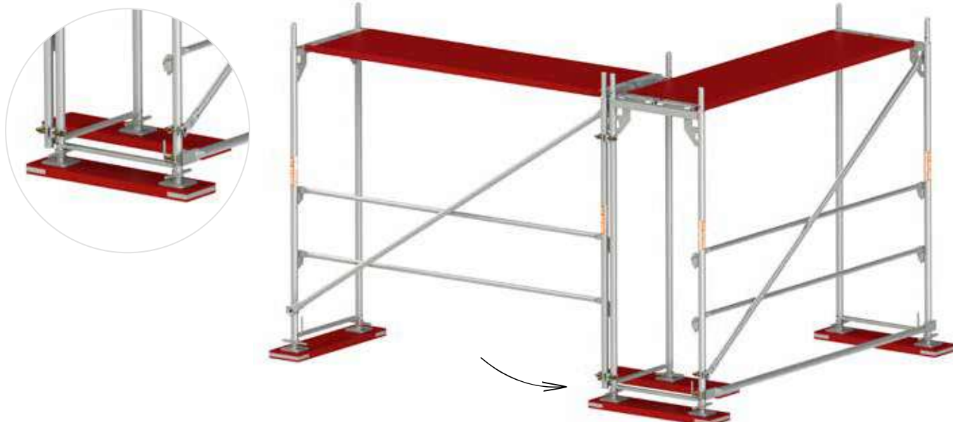
Rys. 29b. Wykonanie narożników za pomocą złączy obrotowych.
