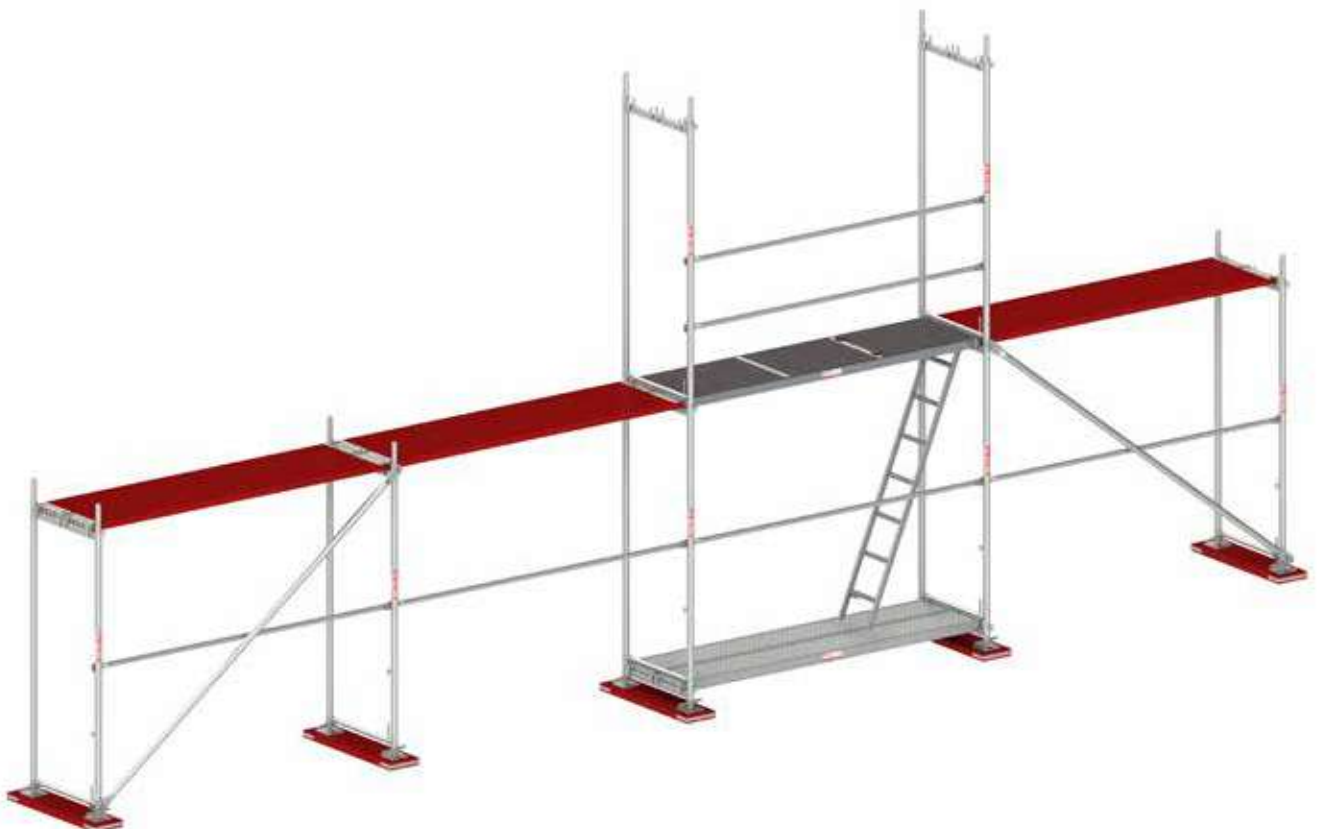
Rys. 8a. Montaż pierwszych ram i poręczy drugiej kondygnacji.
