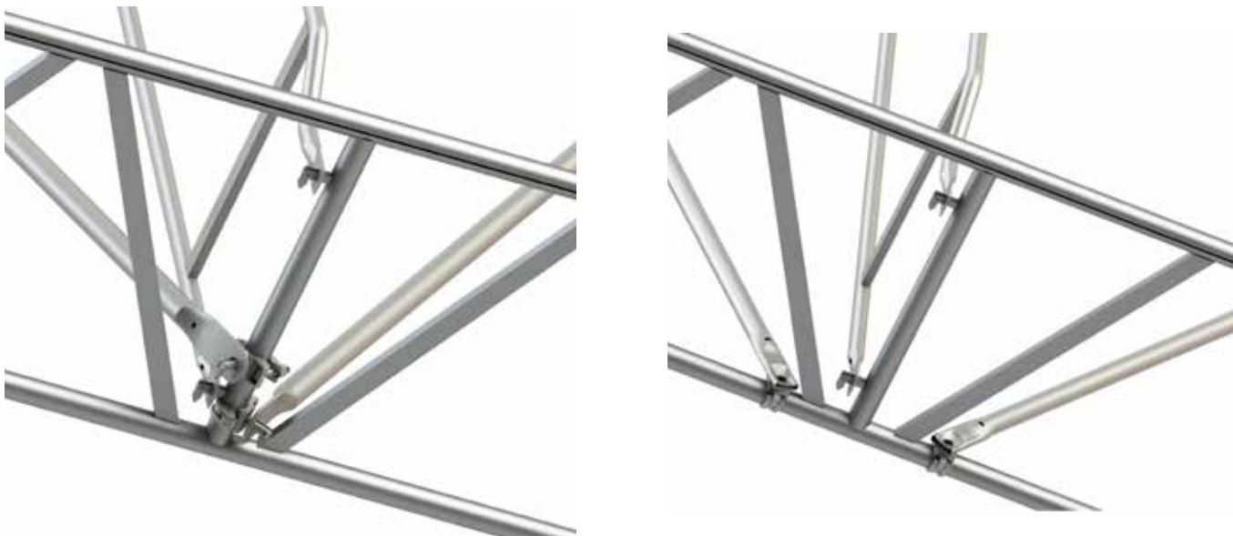
Rys. 58 Szczegół zamocowania stężeń dachowych.
