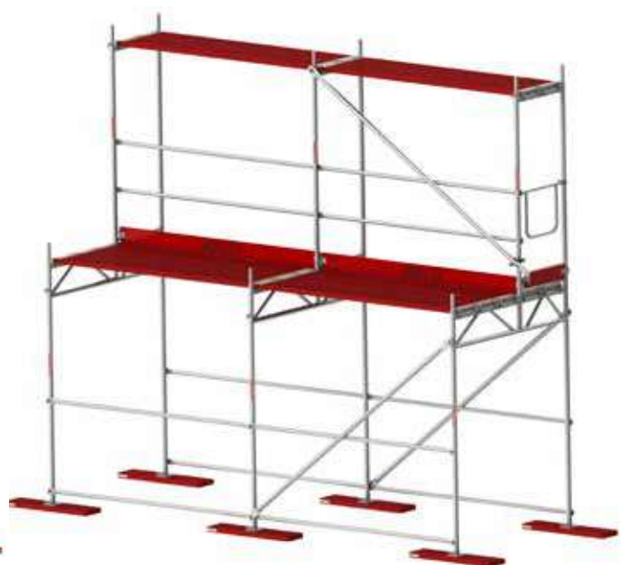
Rys. 26b. Rama przejścia 1,80m.
