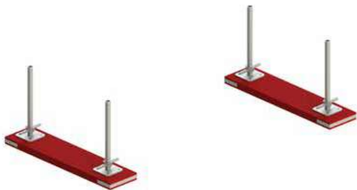
Rys. 2a. Posadowienie rusztowań na podkładach drewnianych.
