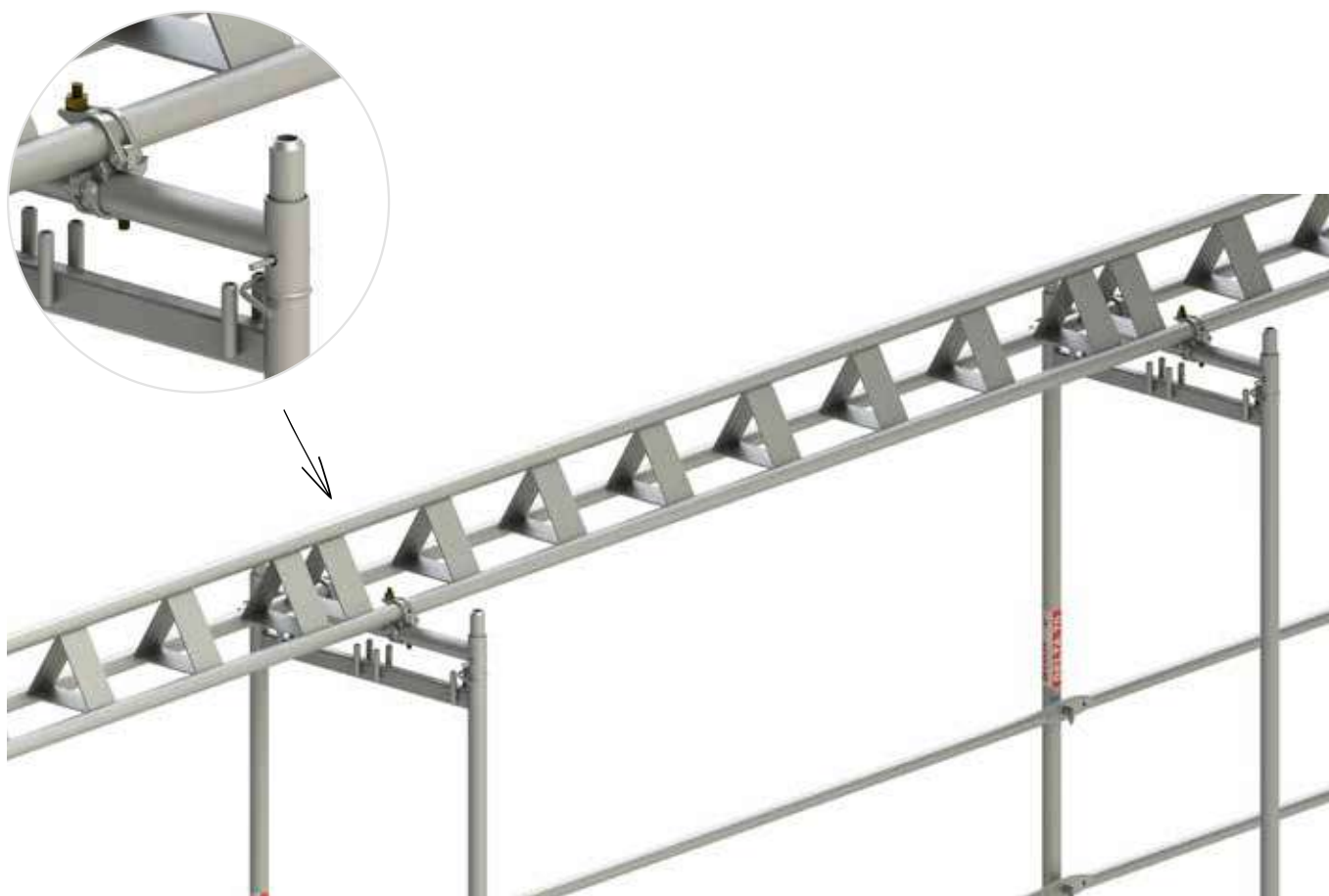
Rys. 65 Montaż szyny prowadzącej dach oraz łącznika szyny z ramą.
