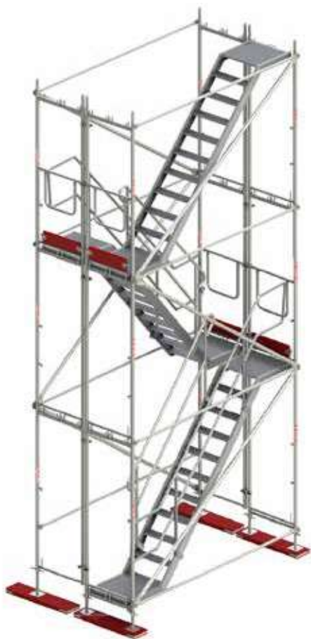
Rys. 45 Montaż klatki schodowej etap VI.
