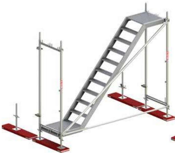
Rys. 40 Montaż klatki schodowej etap I.
