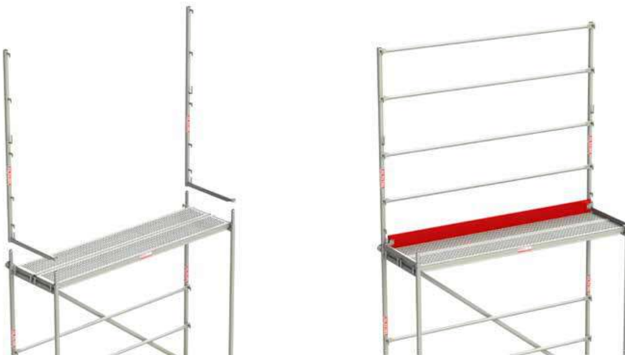
Rys. 18. Montaż słupków dekarских.
