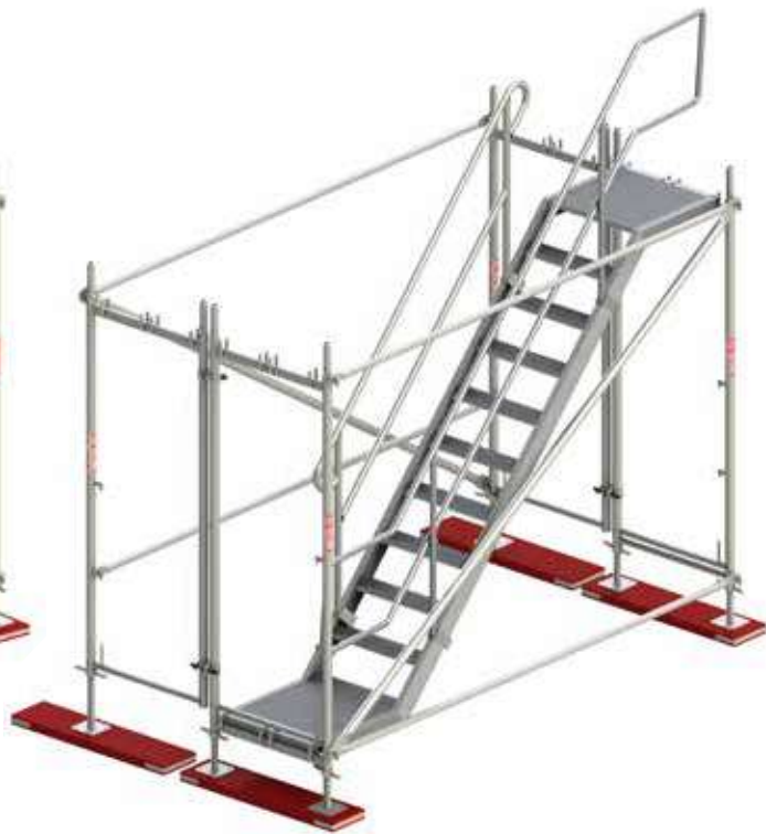
Rys. 41 Montaż klatki schodowej etap II.
