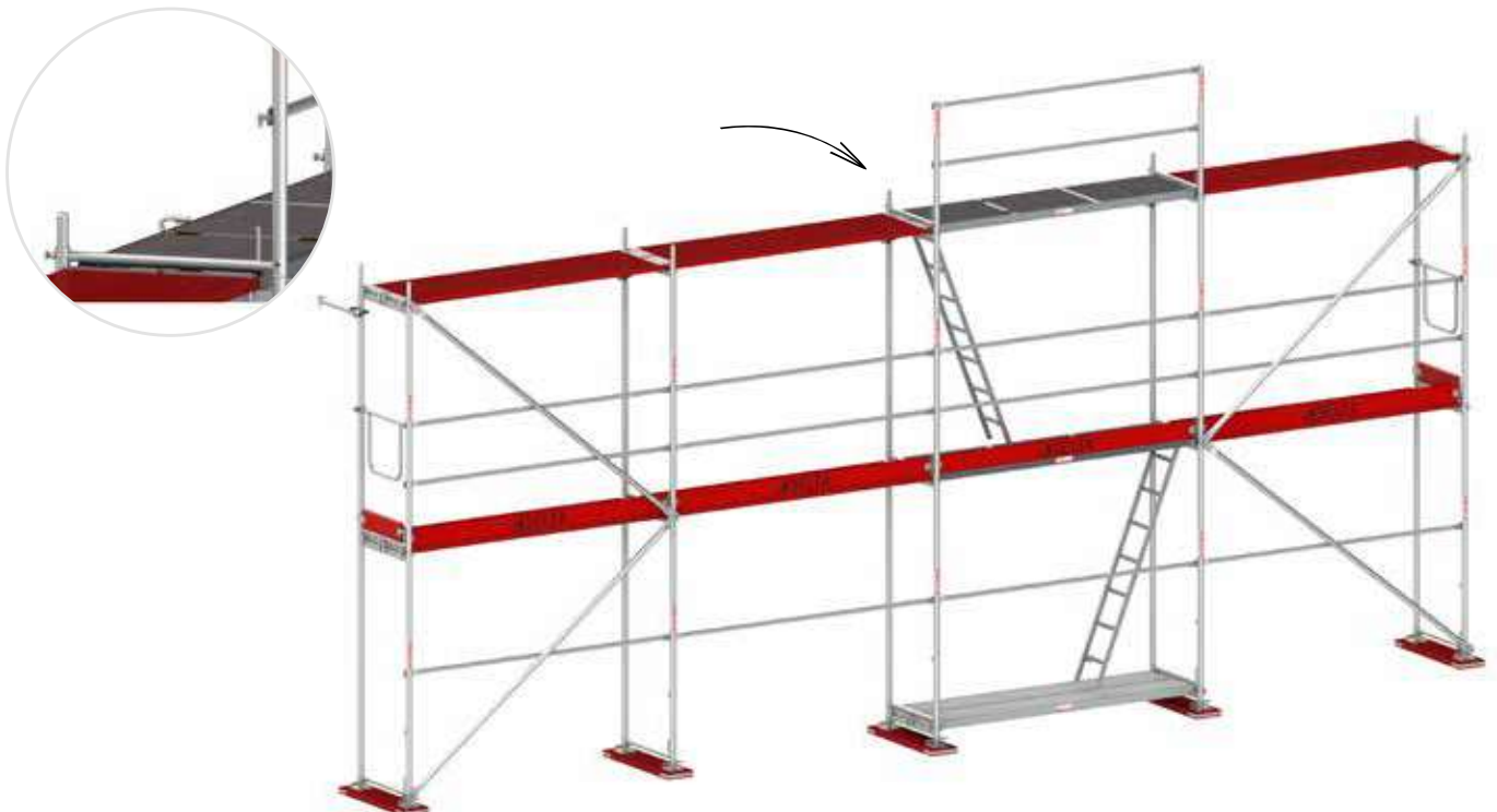
Rys. 10. Montaż słupków poręczowych z zabezpieczeniem pomostów.
