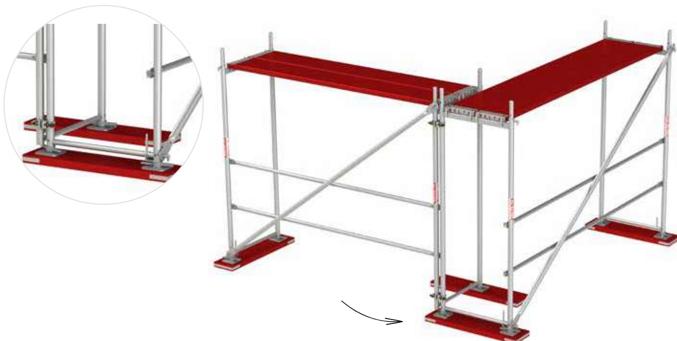
Rys. 29b. Wykonanie narożników za pomocą złączy obrotowych.
