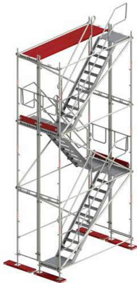
Rys. 46 Montaż klatki schodowej etap VII.
