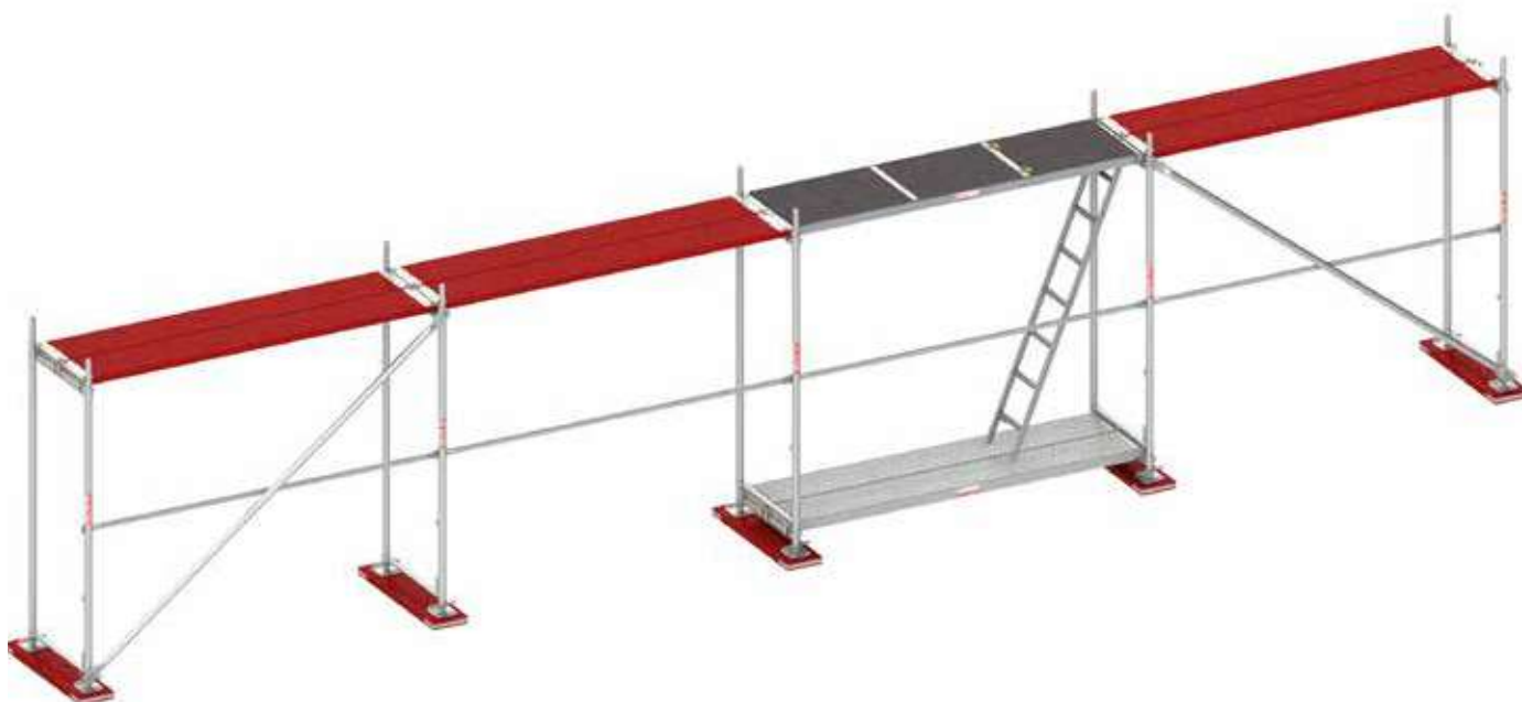
Rys. 6. Zmontowane kolejne pola pierwszej kondygnacji.
