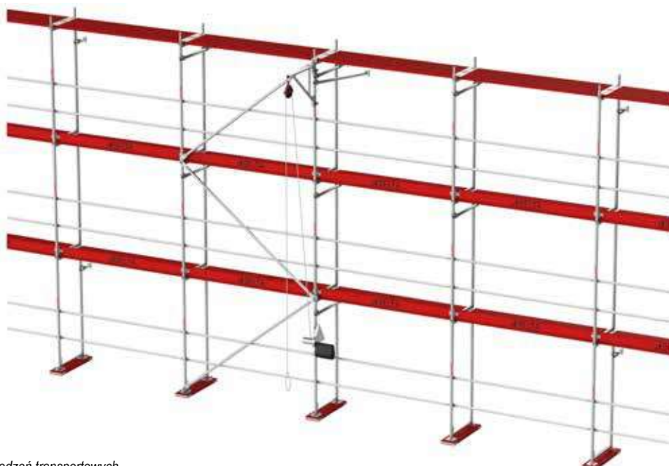
Rys. 32. Montaż urządzeń transportowych.
