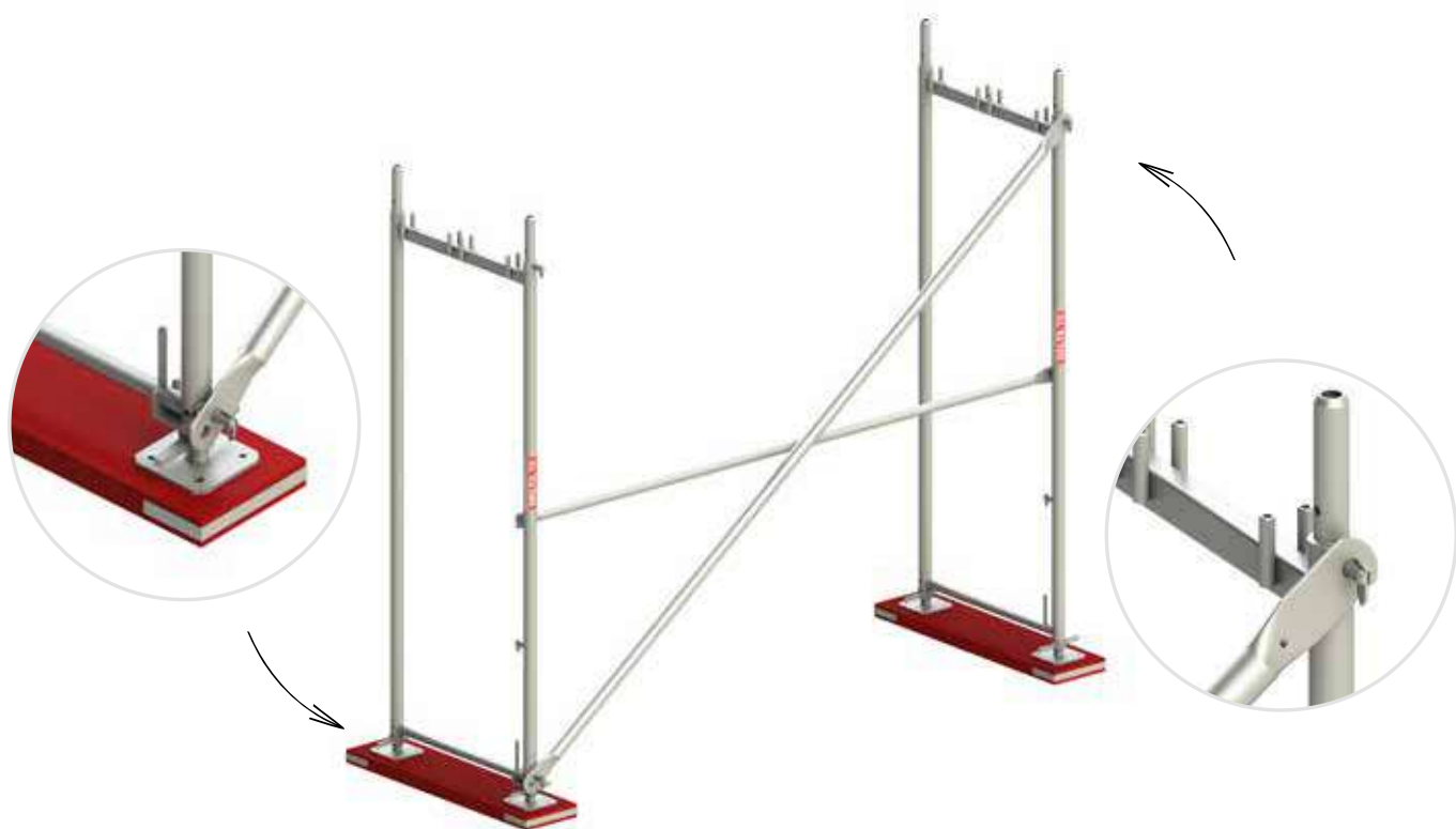
Rys. 4. Montaż pierwszych ram pionowych, poręczy i stężenia ukośnego w polu bazowym.
