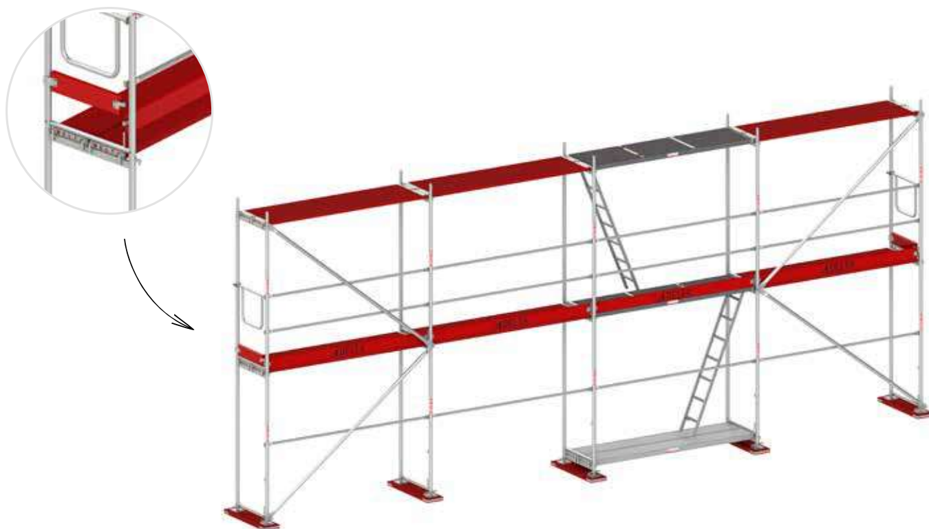
Rys. 8c. Montaż krawężników i podestów.
